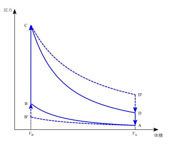
サイクル①ではABCDで囲まれた面積,サイクル②ではAB'CD'で囲まれた面積が 気体がする仕事であり、AB'CD'で囲まれた面積のほうが大きいからサイクル②で気体 が外部にする仕事の方が大きい
